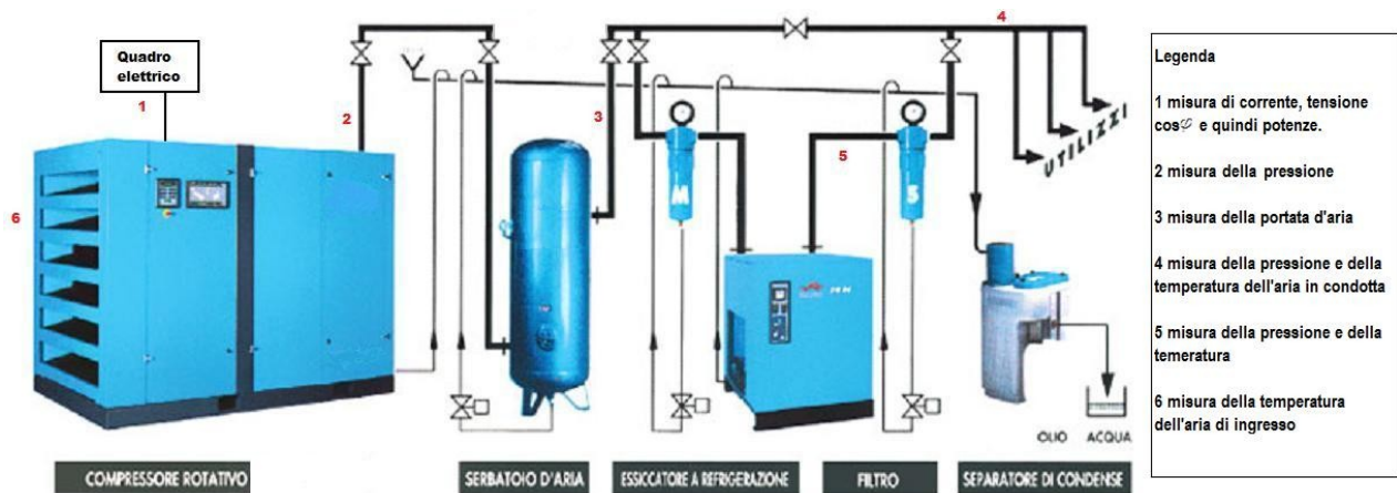
Fig.A2.1 Schema generale di un circuito ad aria compressa con punti di misura riportati sullo schema e in legenda.
